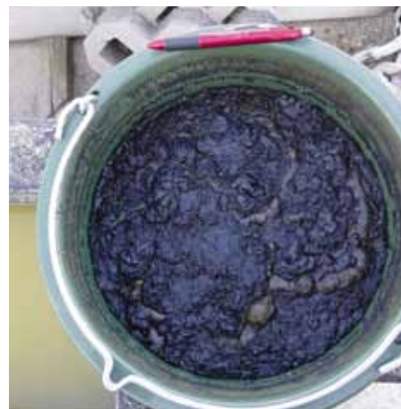
Mit plocher gärrest-aktivator me behandelte Gärrestgülle nach drei Wochen
