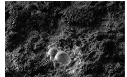
Das zweite Anzeichen der PLOCHER-Wirkung: Blasenbildung, wie hier in einer Größe von 3 bis 5 cm. Mitunter kommen handtellergröße Blasenhaufen zum Vorschein.
