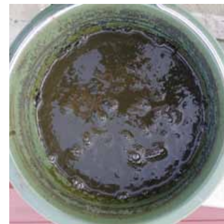
Nach kurzem Aufrühren: Die Probe roch sehr unangenehm und die nicht abgebauten Strukturen waren noch klar sichtbar. In der Farbe war diese Gärrestgülle inhomogen, fleckig und eher hell.
