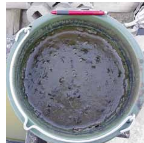
Nach kurzem Aufrühren: Die Probe zeigt sich homogener mit mehr feiner Blasenbildung, geruchsneutral und mit cremiger Konsistenz – aerobe aktive Biologie.
